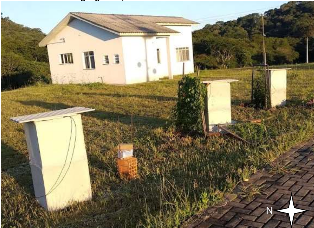
Figura 18 - Protótipos com o material do tipo alvenaria localizados em sentido norte geográfico, com distância entre si de 2m
