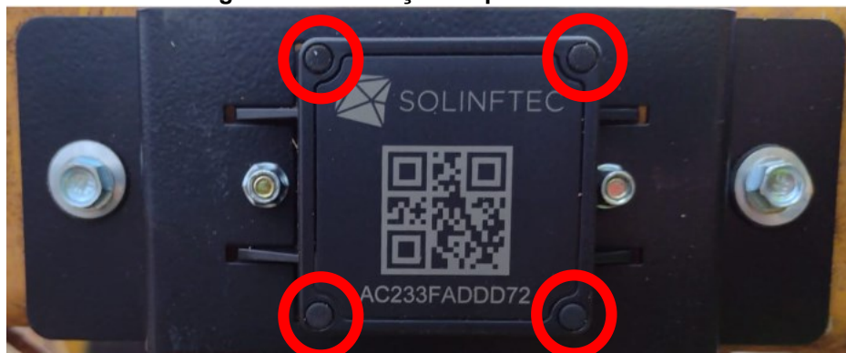
Imagem 1 - Sinalização de parafusos do Beacon
