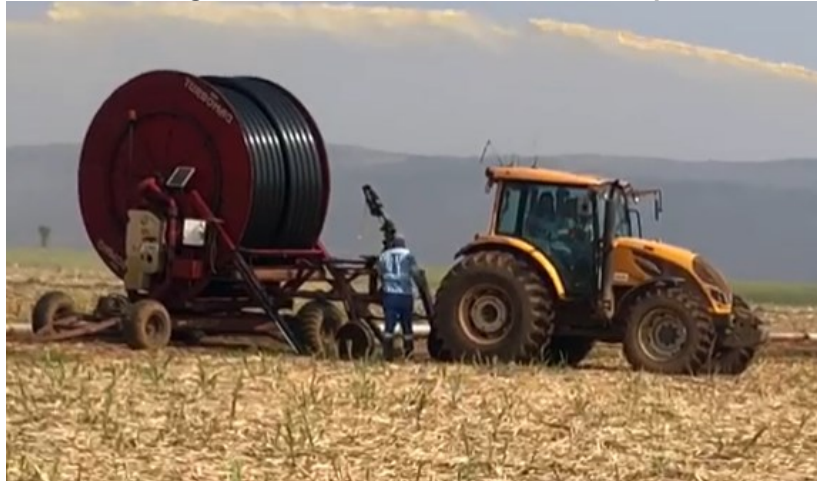
Imagem 2 - Hidro Roll com o trator reboque
