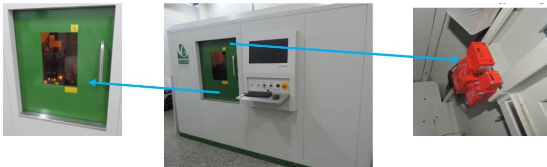
Figura 21 – Imagem da esquerda e centro correspondem ao painel de acesso de serviço e na direita, corresponde a um dispositivo de intertravamento
