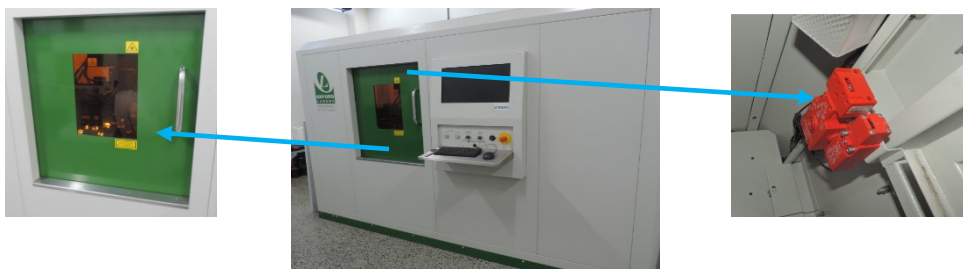
Figura 2 – Exemplo de um painel de acesso ao serviço – zona de ação do laser. Fonte – O autor
