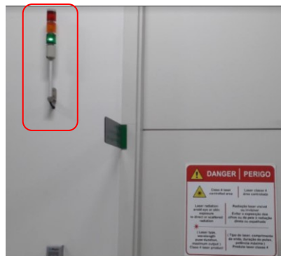
Figura 7 – Exemplo de Luzes de aviso de máquinas a laser destacadas Fonte – O autor
