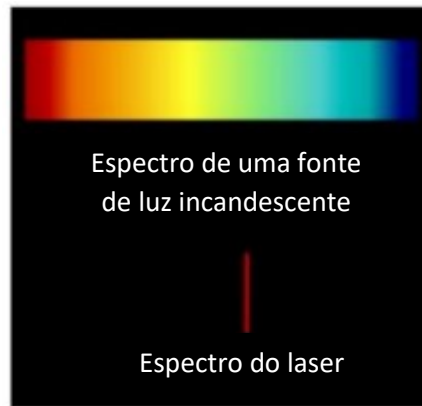
Figura 2 - Comprimento de onda de uma luz incandescente e do laser
