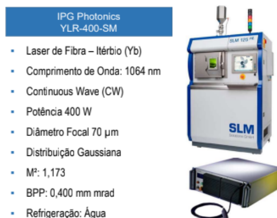
Figura 9 – Máquina SLM-125 com suas características
