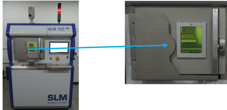
Figura 5 – Caixas de proteção intertravadas de uma máquina de MA marca SLM-125
