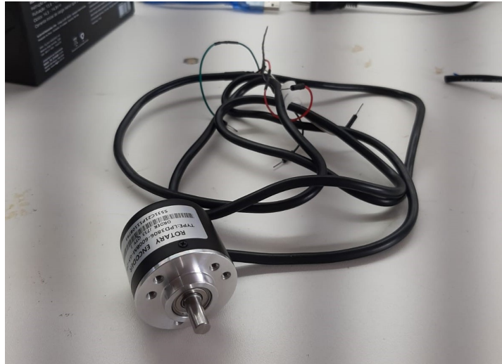
Figura 10 – Encoder rotativo LPD3806-600BM-G5-24C
