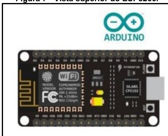
Figura 7 - Vista superior do ESP8266.
