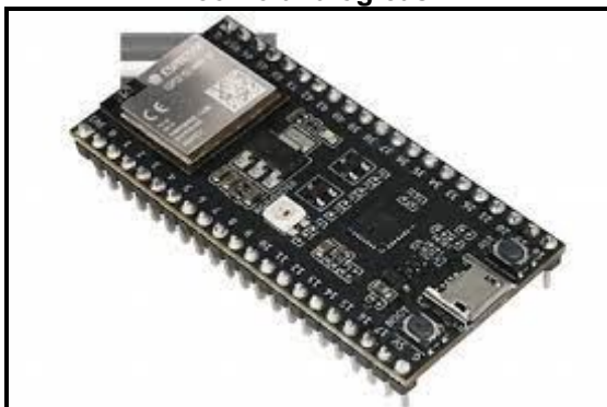
Figura 8 - ESP32 visualmente muito semelhante ao ESP8266 mas com poder de processamento e disponibilidades de GPIOs que permitem operar tanto com variáveis digitais como analógicas
