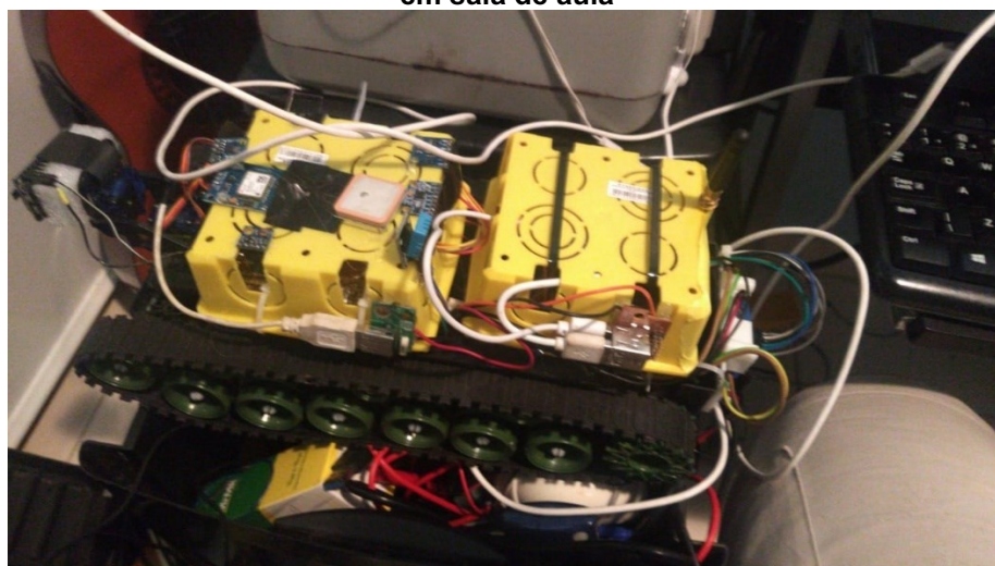
Figura 30 - Montagem do Rover sobre um chassi de tanque, contendo os sensores trabalhados em sala de aula
