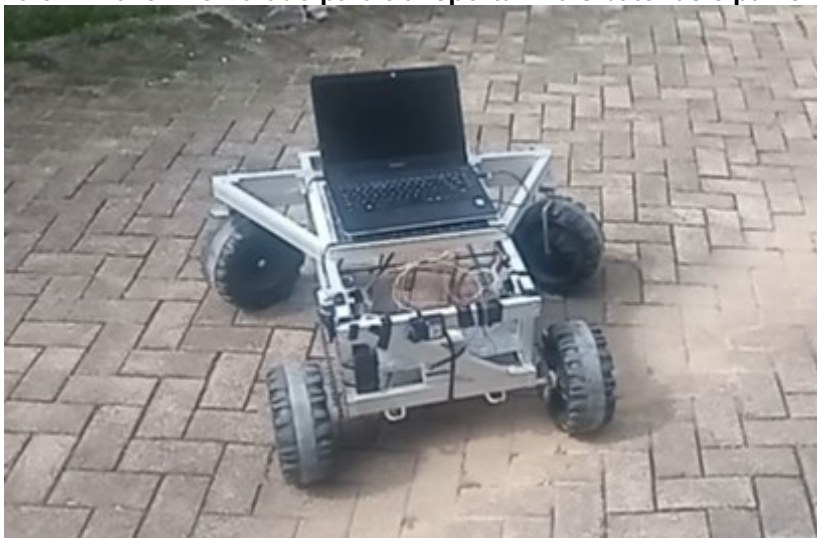
Figura 31 - Rover melhorado para transportar mais baterias e painel solar
