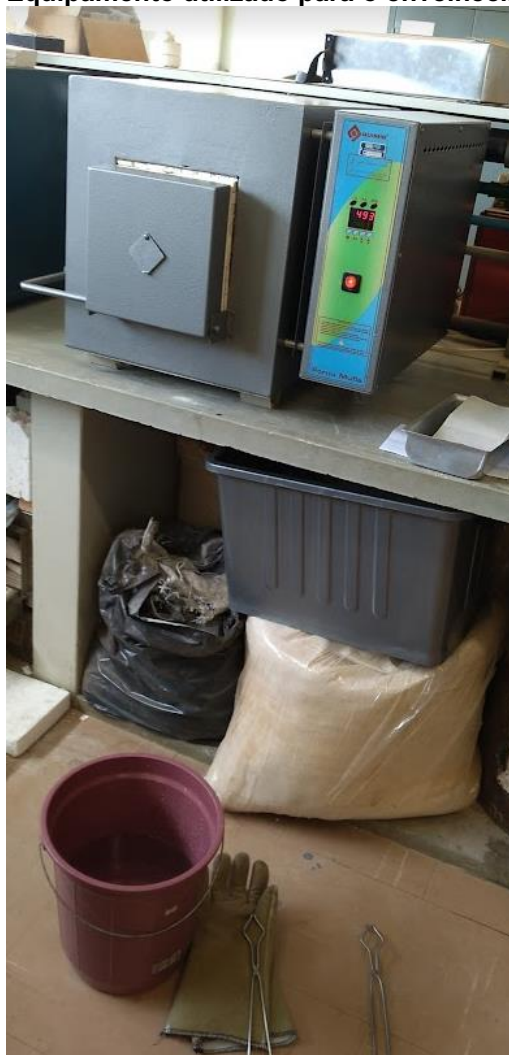
Fotografia 3 – Equipamento utilizado para o envelhecimento artificial
