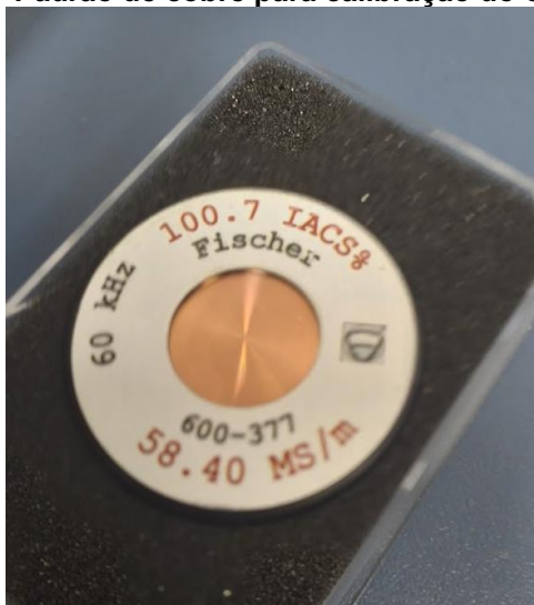
Fotografia 7 – Padrão de cobre para calibração do condutivímetro
