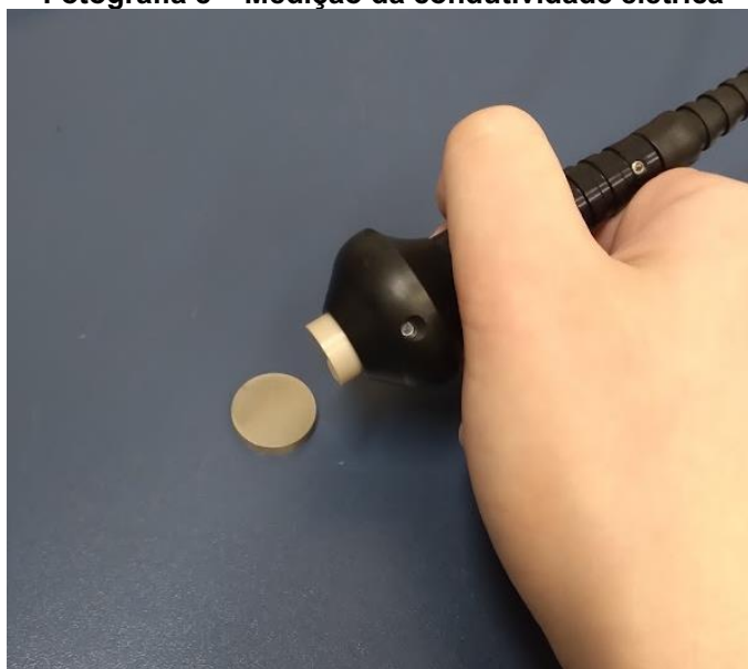
Fotografia 8 – Medição da condutividade elétrica
