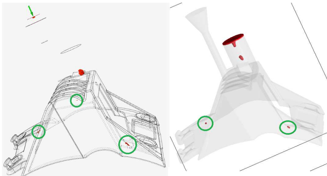
Figura 26 - Microporosidade Malha de 2.5 mm Altair Inspire Cast / NovaFlow & Solid Diâmetro 49 mm
