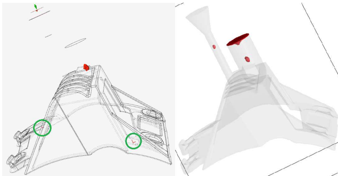
Figura 24 - Microporosidade Malha de 3.5 mm Altair Inspire Cast / NovaFlow & Solid Diâmetro 49 mm
