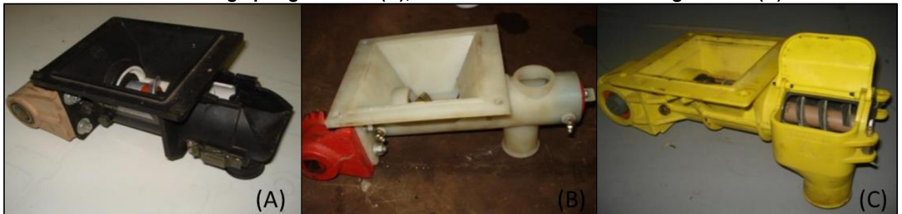
Figura 3 - Dosador tipo sem-fim com descarga por transbordo transversal(A); dosador tipo sem-fim com descarga por gravidade (B); dosador sem-fim com descarga lateral (C).
