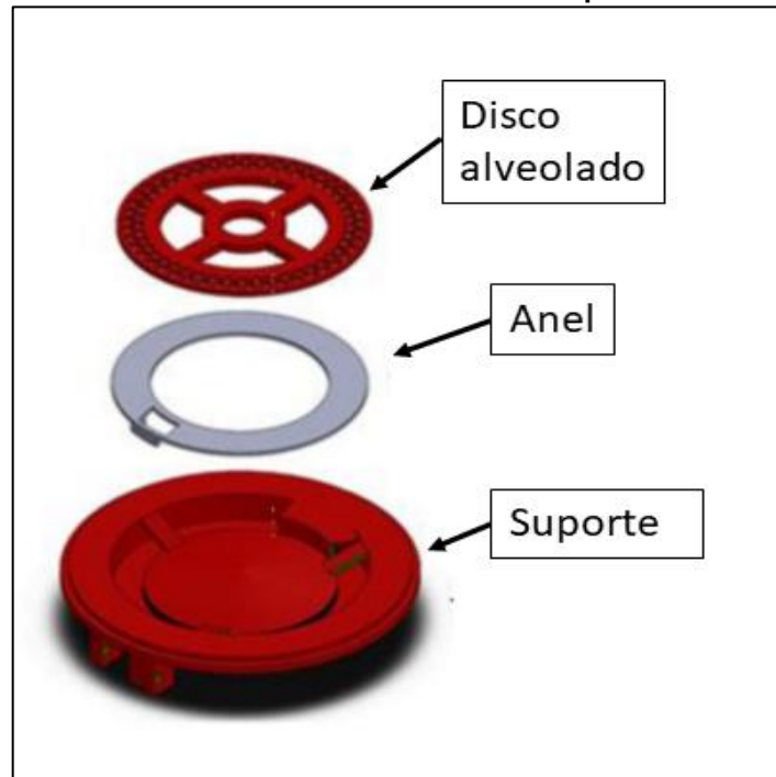
Figura 5 - Mecanismo dosador de sementes tipo disco horizontal
