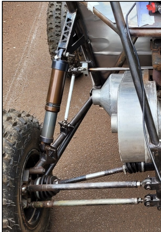
Figura 1 – Sistema de suspensão traseira three-link
