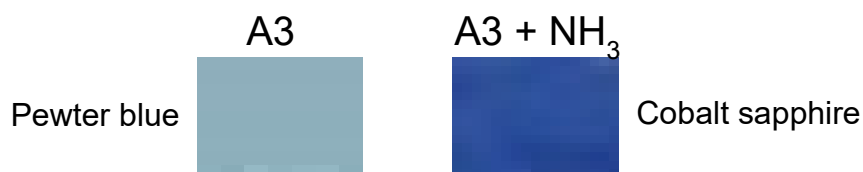
Figura18 - Composto A3 antes e após a exposição à amônia (A3+ NH 3 ).
