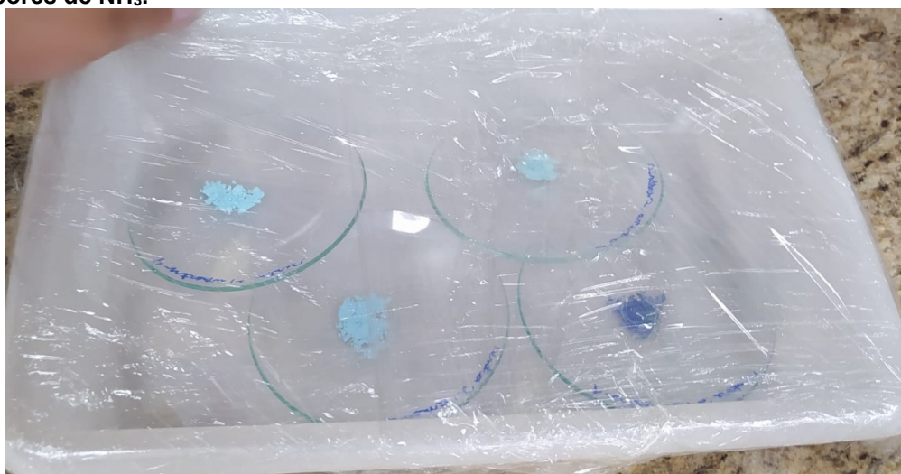
Figura 8 – Estudo do comportamento vapocrômico dos complexos A1, A2 e A3, expostos à vapores de \text{NH}_3 .
