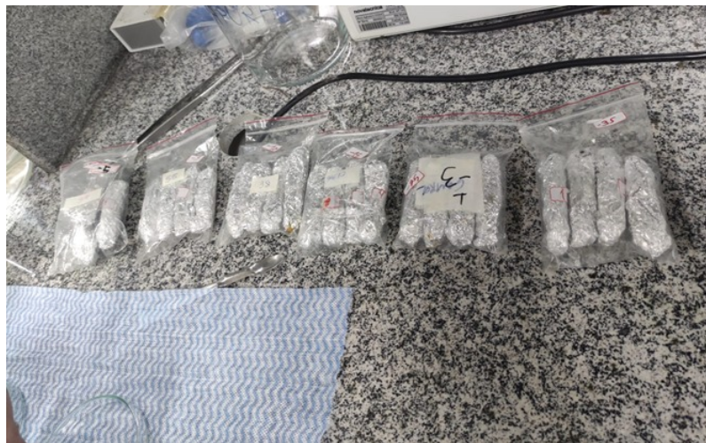
Figura 1 – Tecidos enrolados em papel filme umedecidos e papel alumínio, com as 6 amostras que vão ser expostas nas 6 temperaturas avaliadas, com as devidas 4 repetições. Esses ‘cartuchinhos’ serão levados ao equipamento Huber – Ministat 240 para que seja possível através de um banho termostático alcançar as temperaturas desejadas
