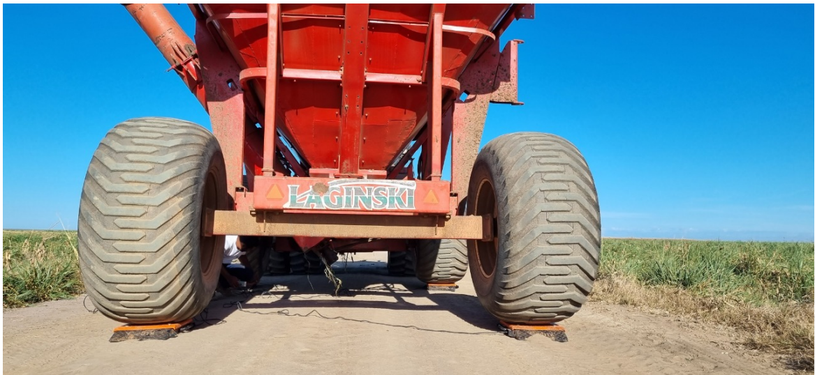
Figura 3 – Carreta graneleira sendo pesada com balança de carreta
