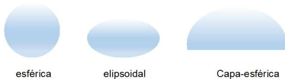
Figura 4 - Formatos de bolha escoamento livre em um meio infinito sobre a influência da gravidade.
