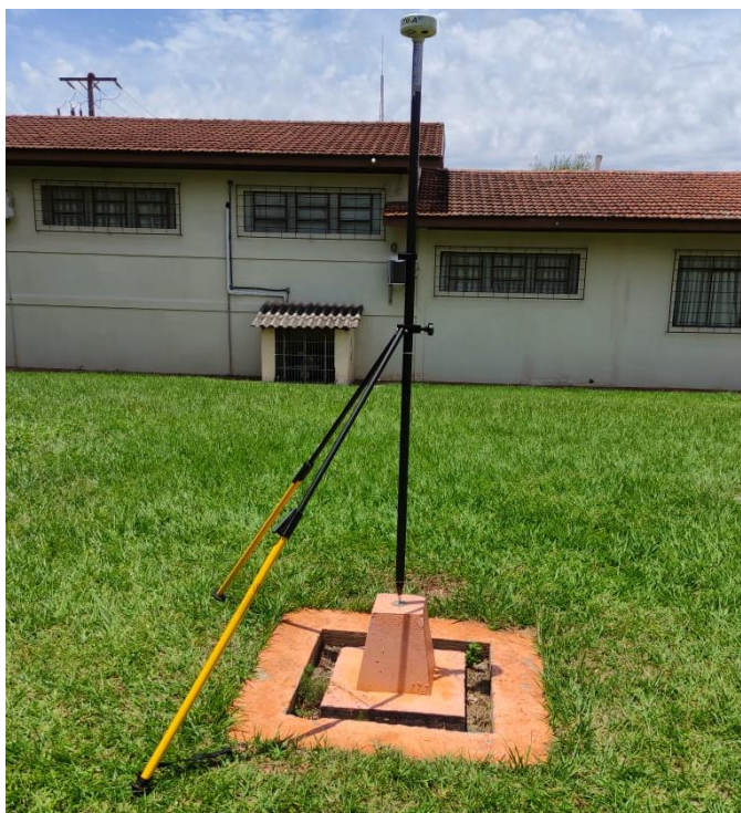
Figura 17- Receptor GPS sobre RN com coordenadas conhecidas (BASE)
