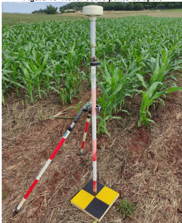
Figura 16- Rover sobre ponto de apoio
