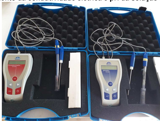
Fotografia 4 – Condutivímetro a (esquerda) e pHmetro à (direita) utilizados para o monitoramento da condutividade elétrica e pH da solução nutritiva.
