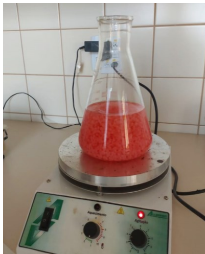
Fotografia 1 - Erlenmeyer com as cápsulas sendo agitadas em agitador magnético
