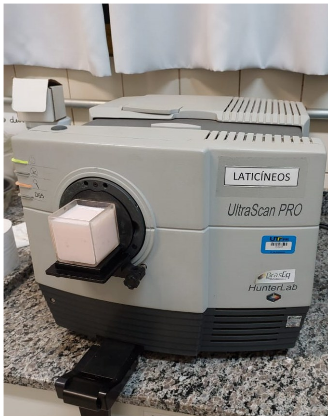
Fotografia 2 - Realização de análise de cor de uma amostra em espectrofotômetro
