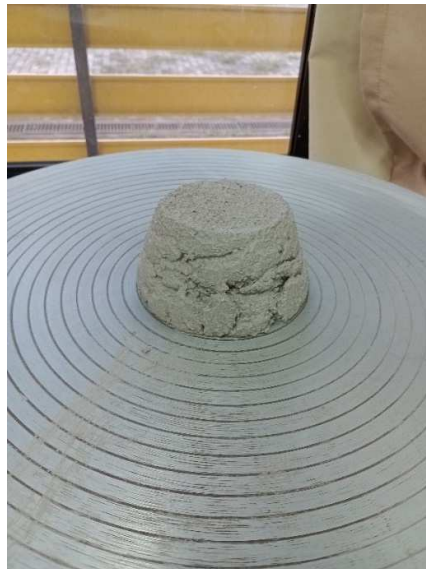
Figura 9 - Argamassa logo após remoção do tronco de cone na flow table
