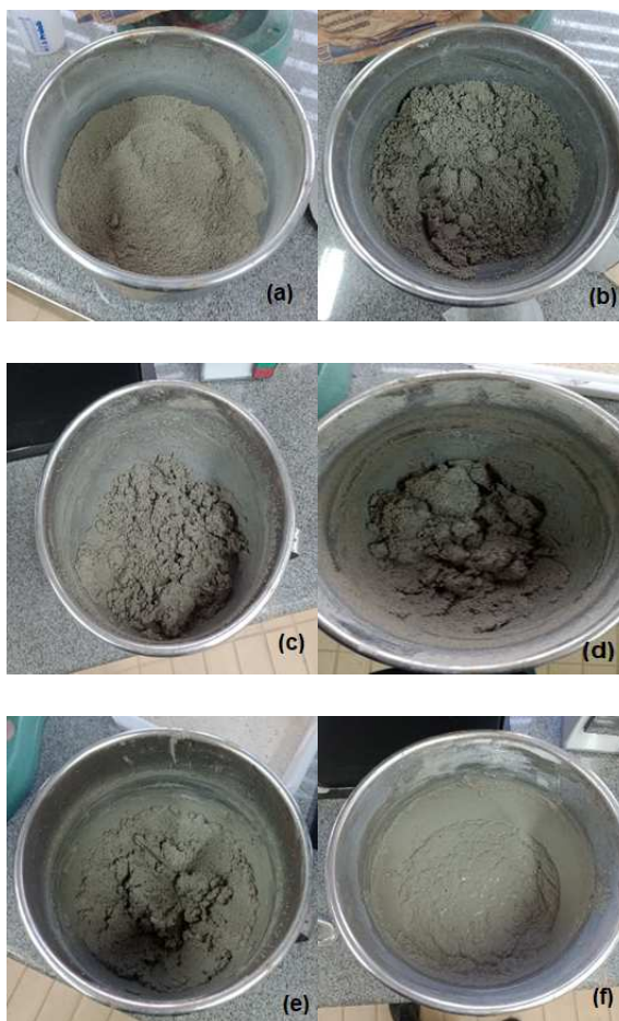
Figura 8 - Aspecto das argamassas produzidas. Relação água cimento de: (a) 1,5; (b) 1,75; (c) 2; (d) 2,25; (e) 2,35 e (f) 2,5
