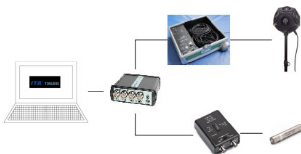
Figura 14 – Conexão dos equipamentos no método da resposta impulsiva integrada.
