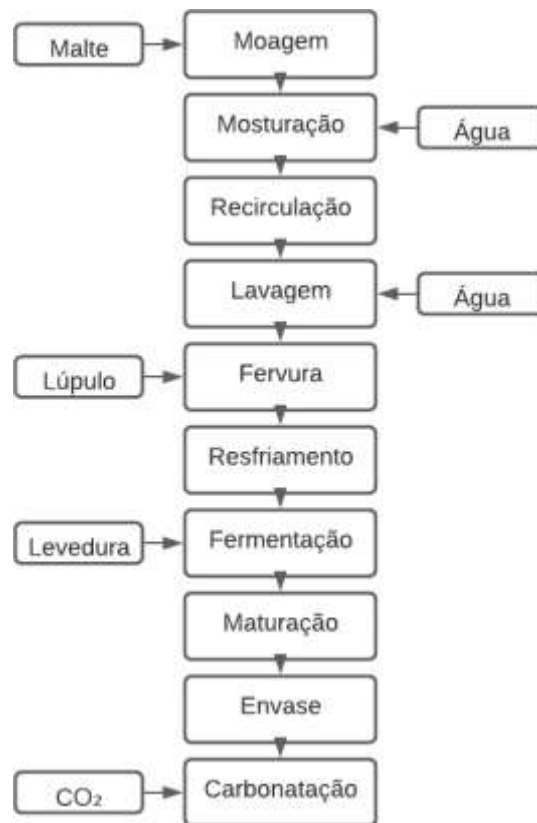
Figura 4 - Fluxograma básico do processo de fabricação da cerveja artesanal
