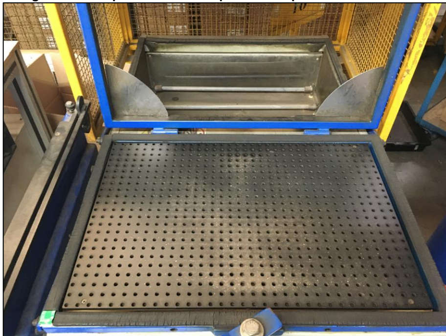
Figura 10 - Máquina Skin com aquecimento por resistência elétrica
