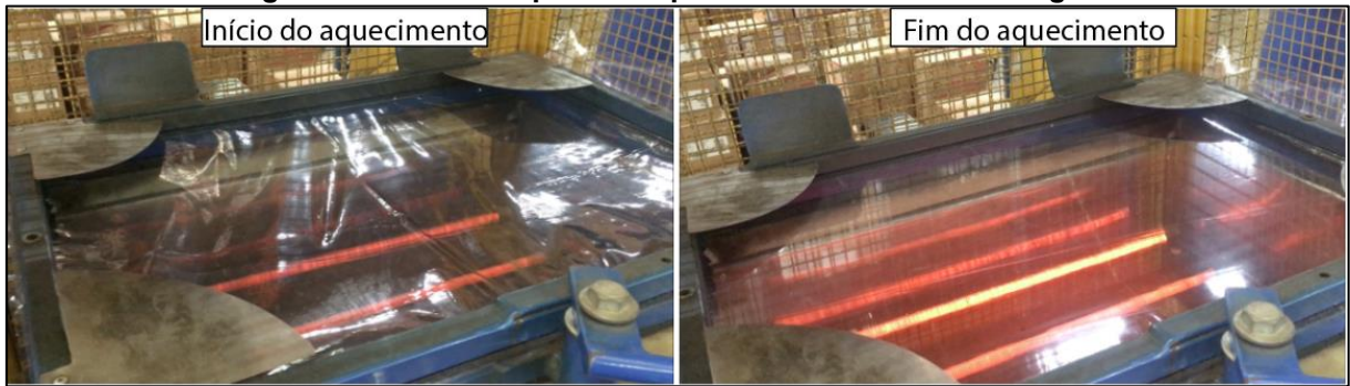
Figura 8 – Antes e depois de aquecimento em termoformagem
