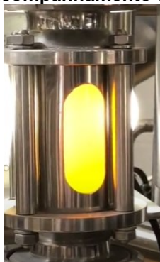
Figura 3 – Visor para acompanhamento da clarificação
