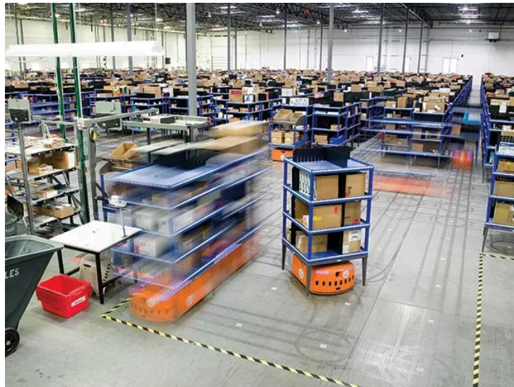
Fotografia 1 – Robôs do sistema KIVA trabalhando em um armazém da Staples em Denver/CO Fonte: Fotografia de Joel Eden (GUIZZO, 2008).
