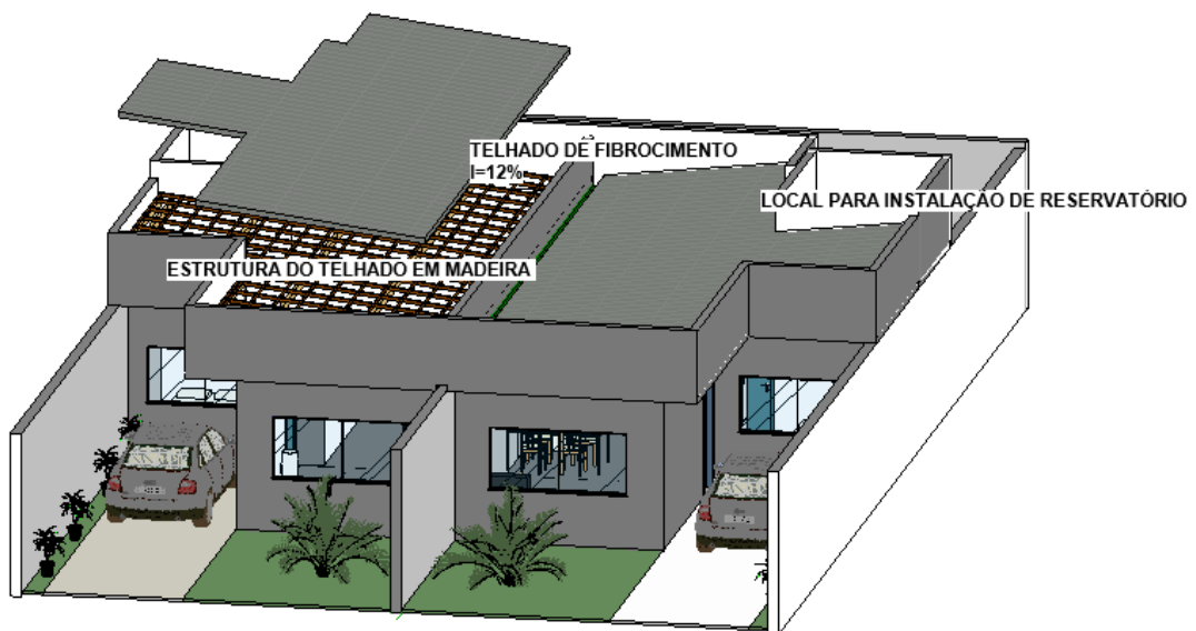
Figura 6: Vista explodida do telhado da residência
