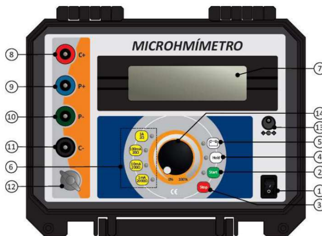
Figura 7 – D Microhmímetro utilizado em subestações para medição de resistência de isolamento
