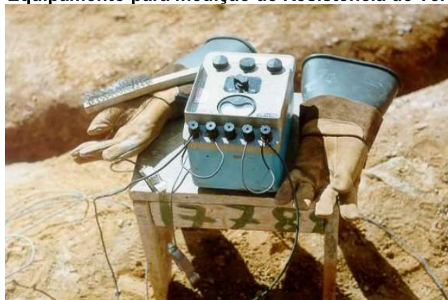
Figura 26 - Equipamento para medição de Resistência de Terra – Megger
