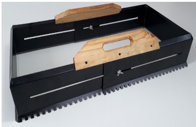
Figura 37 - Carrilho protótipo 3 aberto (90cm)
