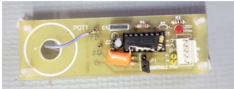
Fotografia 1 - Controlador SG3524 na placa de circuito impresso
