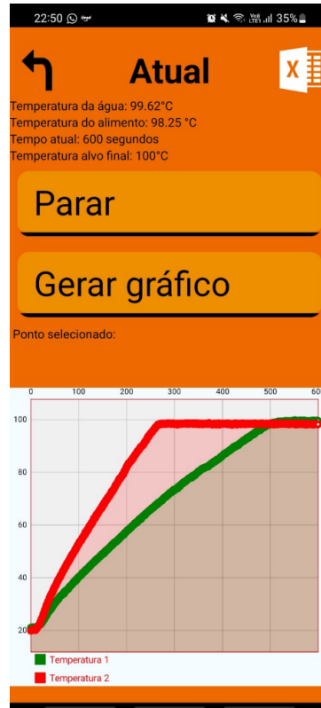
Figura 15 – Resultado do teste dos dois termopares em recipientes diferentes
