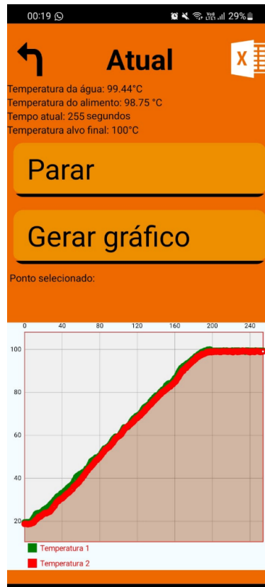
Figura 16 – Resultado do teste dos termopares no mesmo recipiente
