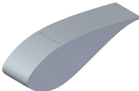
Figura 26 – DU 97-W-300 com VGs perfil NACA 0012
