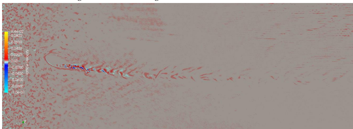
Figura 39 – Vorticidade gerada à um AoA de 15° e Re = 3 \cdot 10^6
