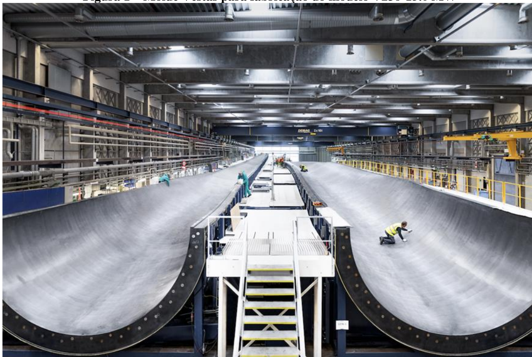
Figura 1 – Molde Vestas para fabricação do modelo V236-15.0 MW
