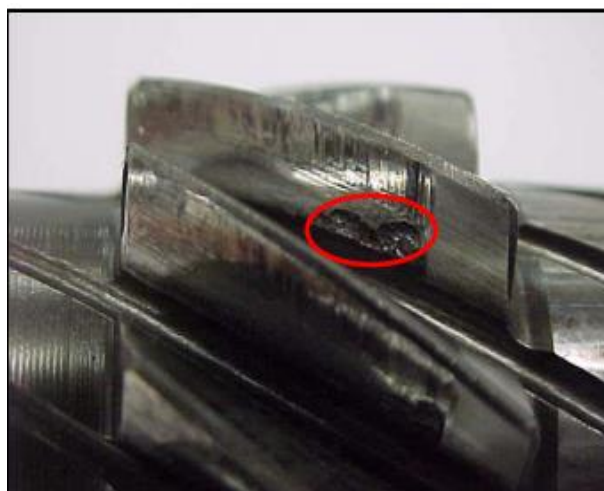
Figura 14 - Modo de falha devido a extremidade direita sobrecarregada
