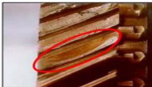
Figura 13 - Quebra do dente de e por fadiga de flexão
