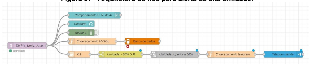
Figura 37 - Arquitetura de nós para alerta da alta umidade.
