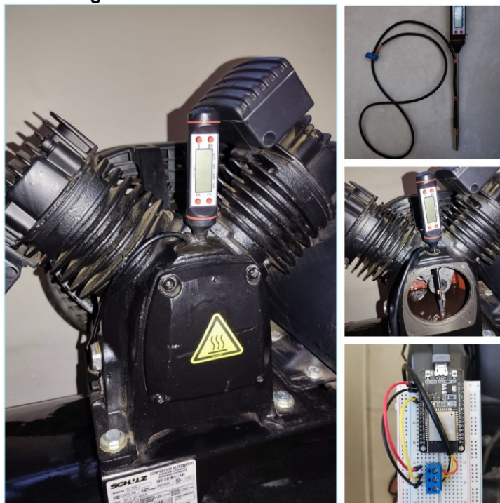
Figura 24 - Montagem de sensor e termômetro no cárter do compressor.
