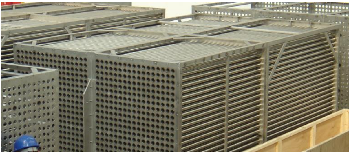
Figura 1 - Trocador de calor com tubos lisos
