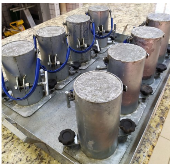
Figura 2 – Confeção dos corpos de prova 100x200mm
