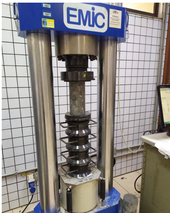
Figura 5 – Ensaio de resistência à compressão axial
