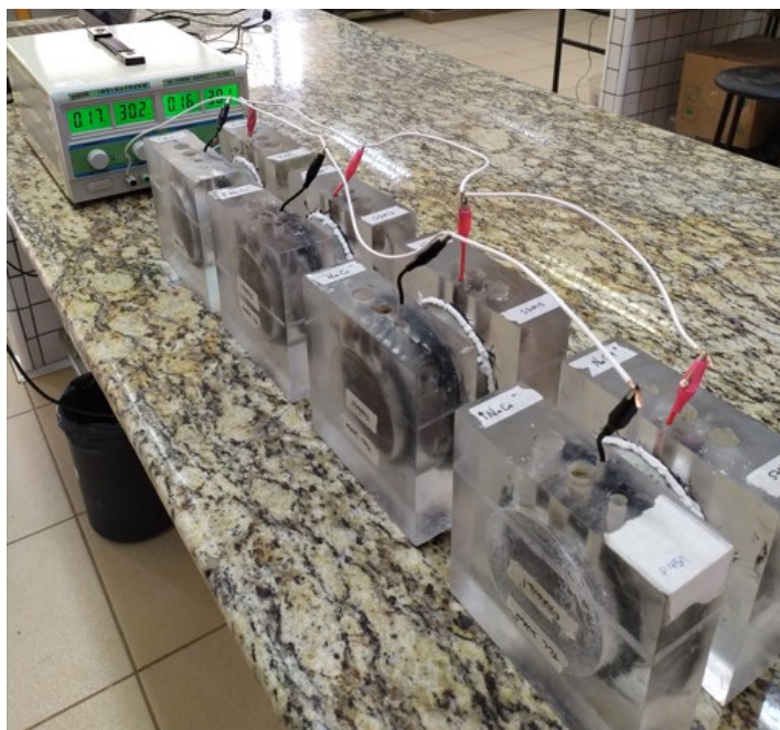
Figura 10 – Sistema final para o ensaio ASTM C1202/19
