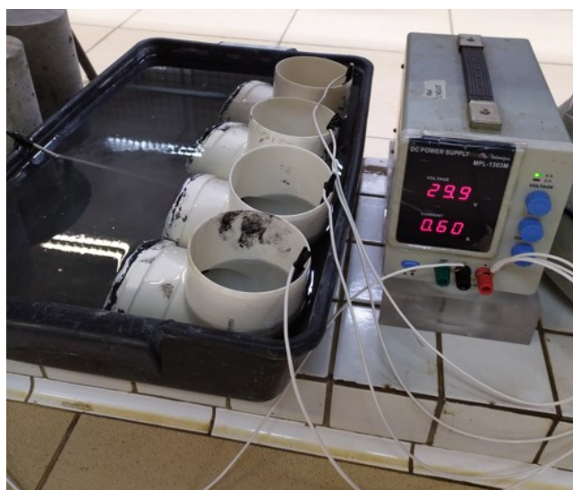
Figura 13 – Sistema final para o ensaio NT BUILD 492/99
