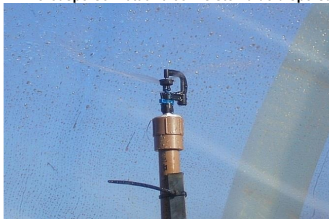
Figura 1 - Microaspersor rotativo com sistema de dispersão a jato
