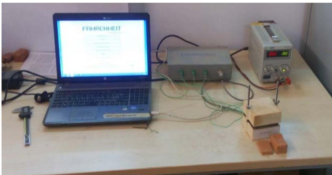
Figura 6 – Sistema DesProTherm para medição da condutividade térmica.
