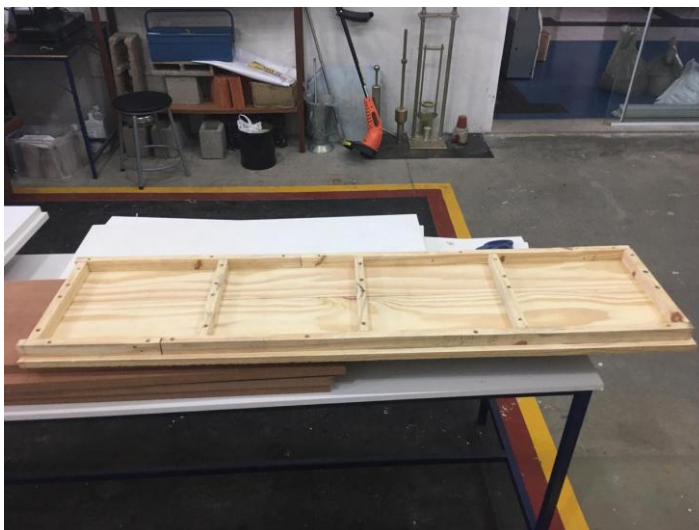
Figura 10 – Montagem das chapas de madeira
