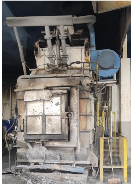
Figura 5– Forno de fusão tipo Torre
