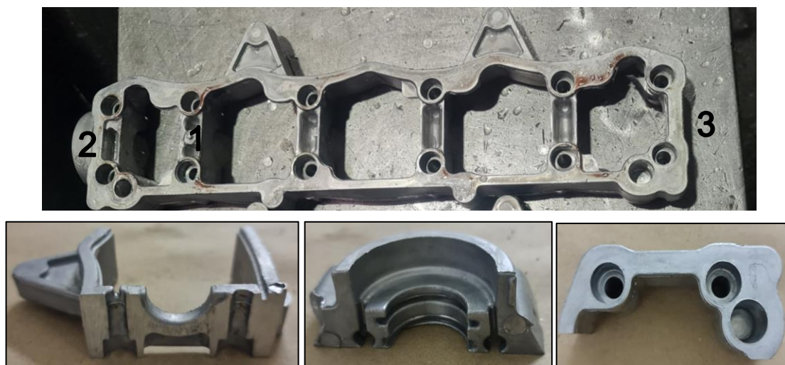
Figura 6- Imagem da peça admissão cortada na fresa. Partes 1, 2 e 3 respectivamente.
