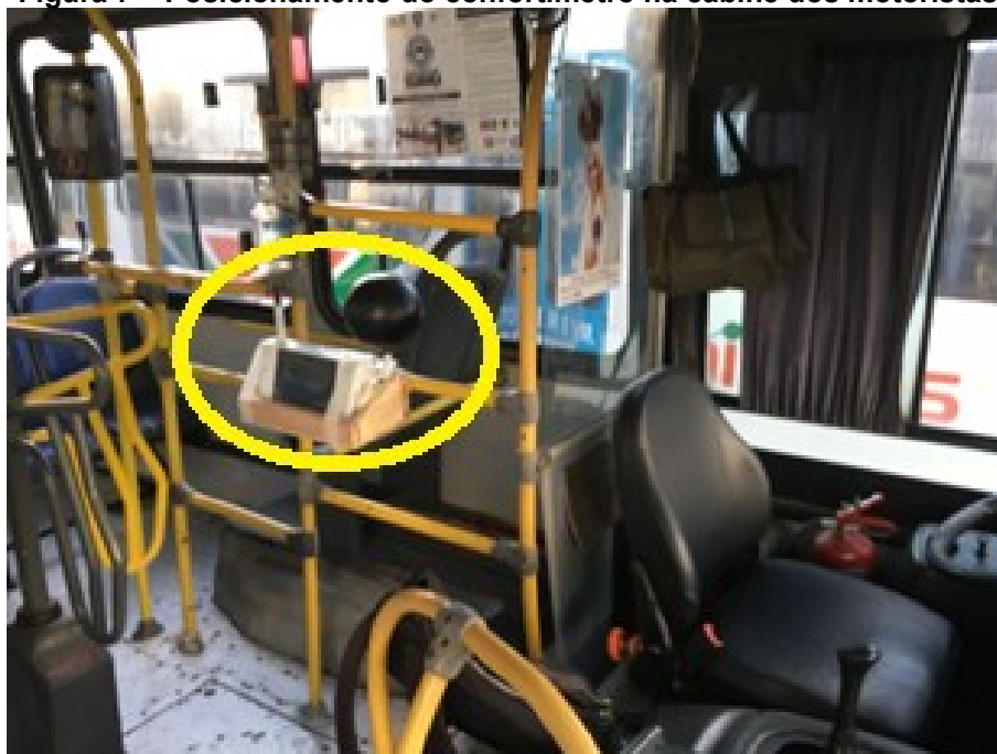
Figura 7 – Posicionamento do confortímetro na cabine dos motoristas
