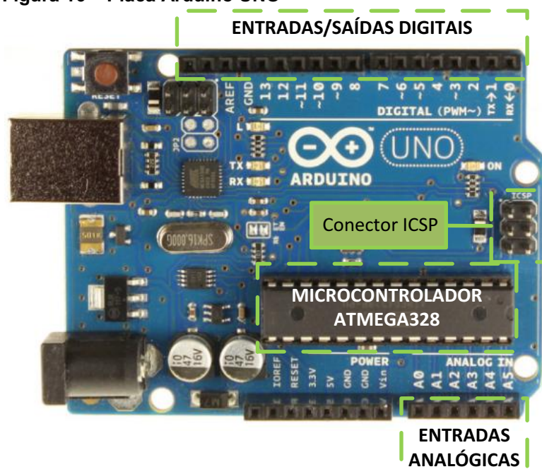
Figura 16 – Placa Arduino UNO
