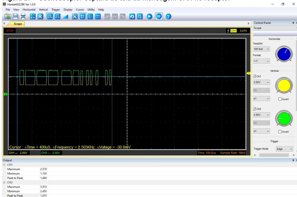
Figura 27 – Osciloscópio: Captura de tela da mensagem CAN no receptor
