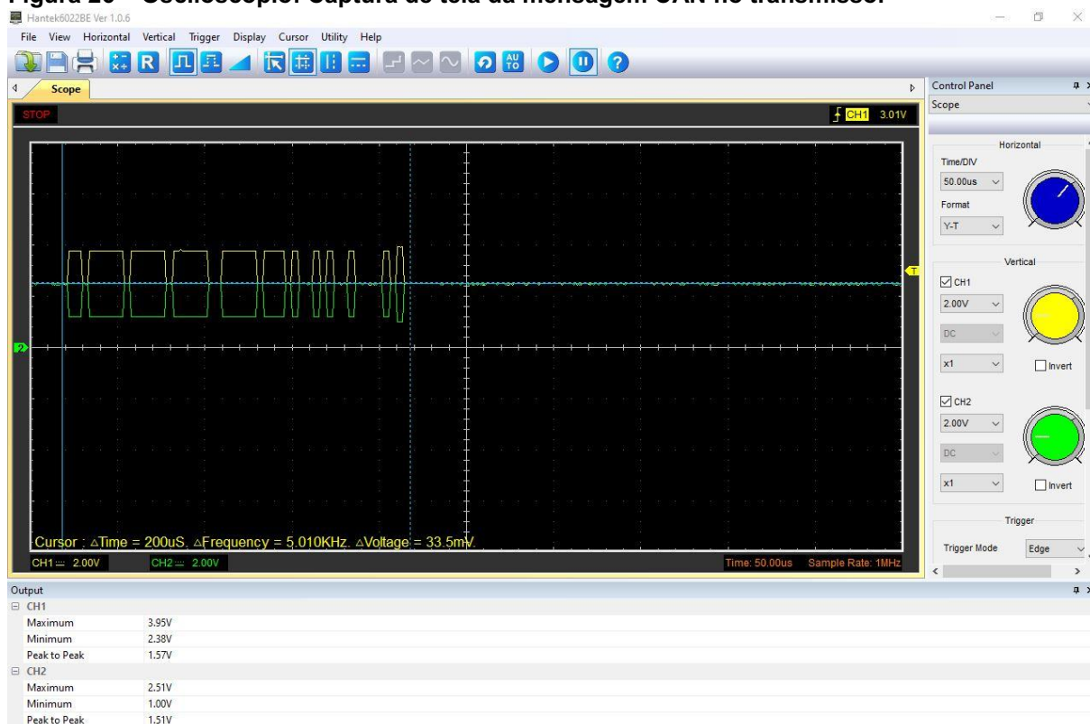
Figura 26 – Osciloscópio: Captura de tela da mensagem CAN no transmissor
