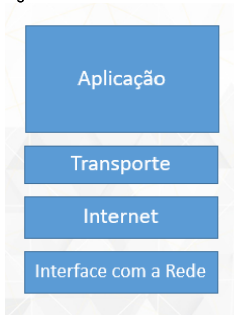
Figura 3 – Modelo de referência TCP/IP
