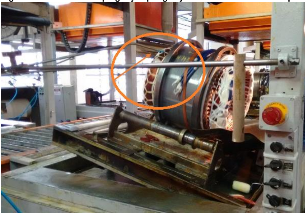
Figura 11 - Sistema de impregnação por gotejamento indicando o bico aplicador de resina
