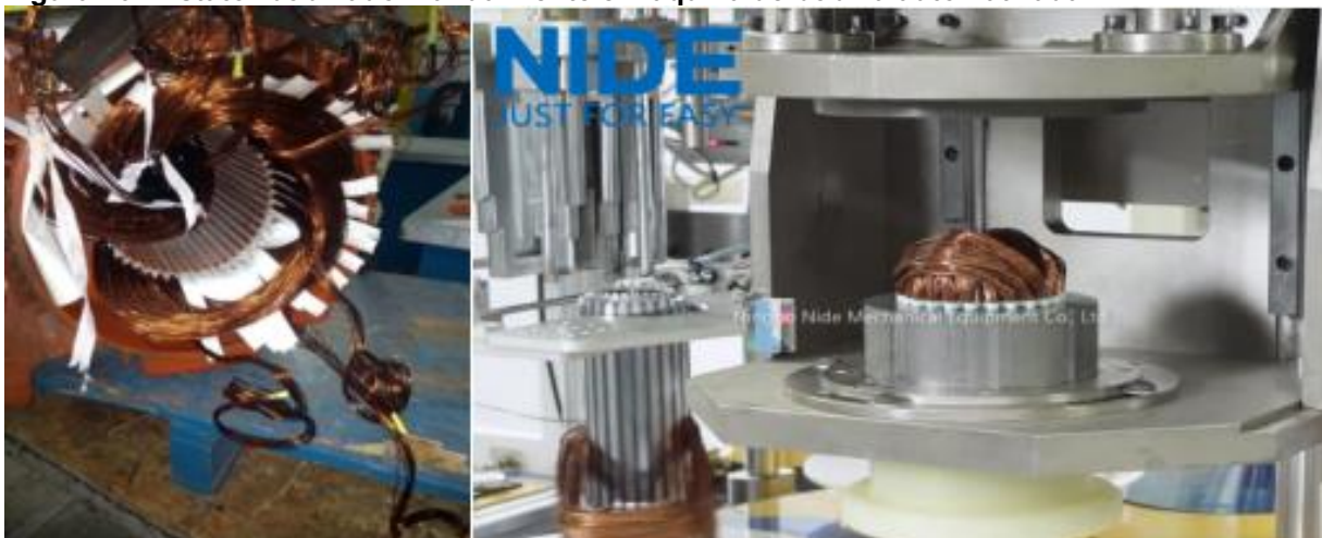
Figura 10 - Estator bobinado manualmente e máquina de bobina automatizada
