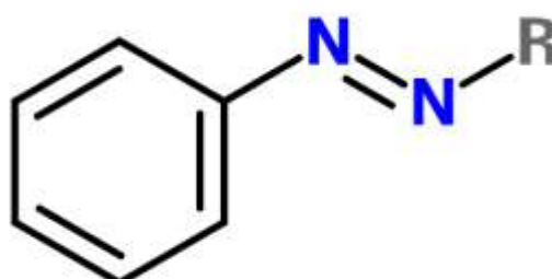
Figura 1 - Estrutura genérica de um corante azo com a representação dos principais grupos químicos
