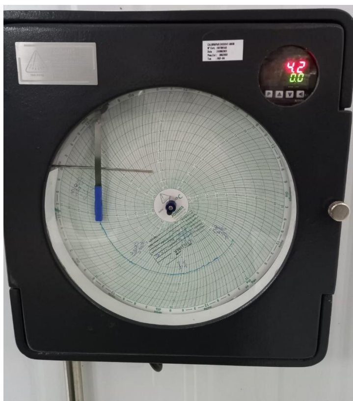
Figura 12: Gráfico de monitoramento de temperatura da câmara de armazenamento de matérias primas.
