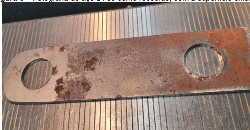
Figura 6 – Fotografia do aço D700 como recebido, com a superfície oxidada
