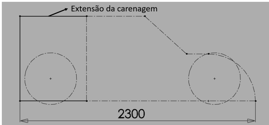
Figura 37 – Esboço lateral da modificação do comprimento da carenagem.
