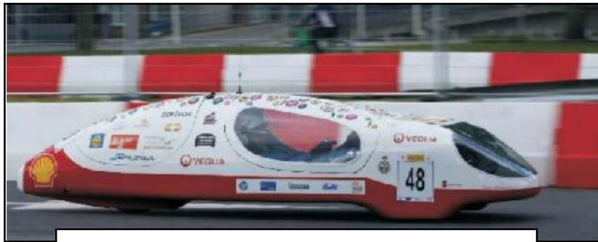
Protótipo polonês – EcoArrow II | C_d = 0,096
