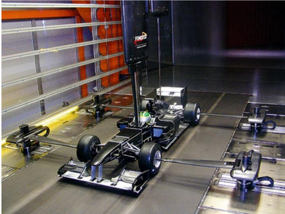
Figura 1 - Túnel de vento utilizado para testes aerodinâmicos em carros de fórmula 1.
