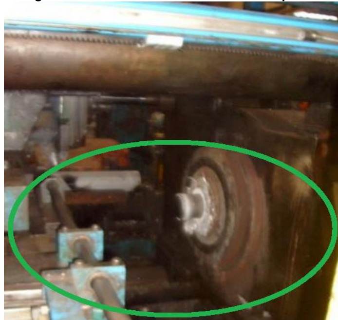
Figura 5 - Bloco fictício no eixo frontal da prensa
