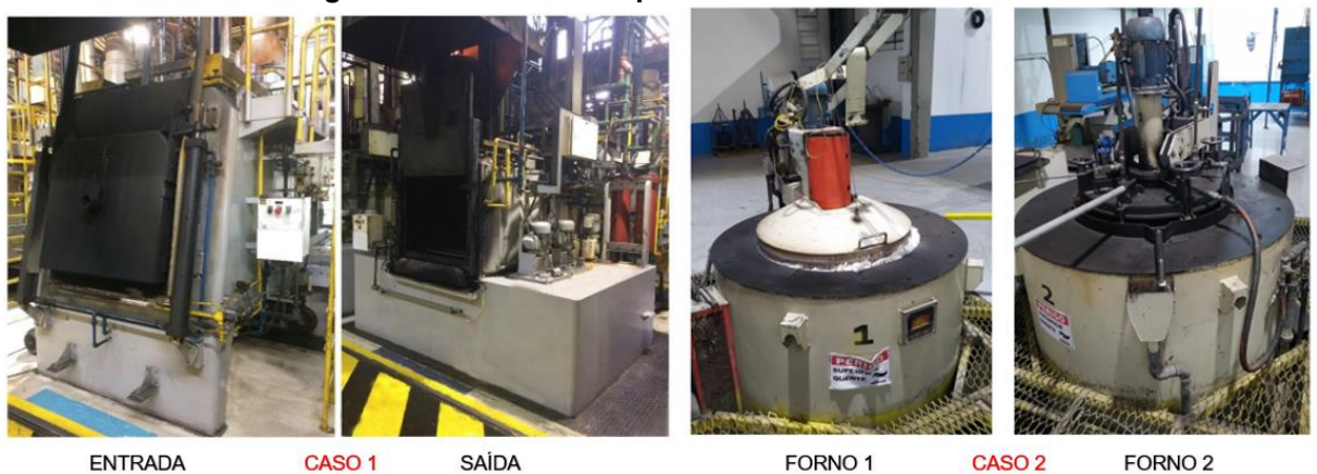
Figura 16 - Forno de tempera e revenimento
