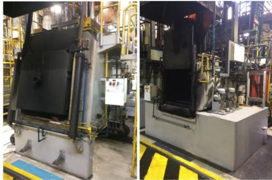
Figura 12- Forno utilizado para a têmpera da carga
