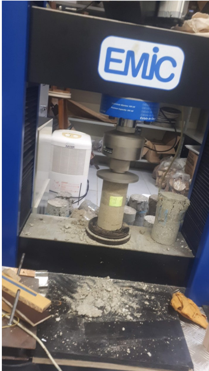
Figura 6: Corpo de prova submetido ao ensaio de Compressão.
