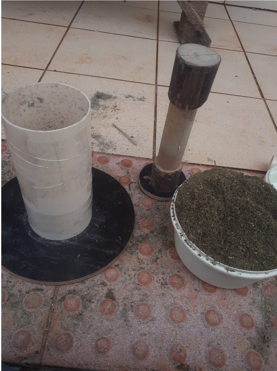
Figura 5: Fabricação do corpo de prova, molde de PVC, pilão e mistura
