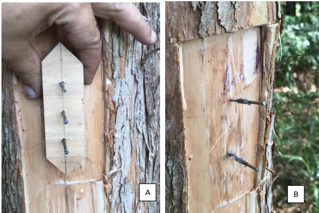
Figura 4 - Gabarito e os pregos já fixados que auxiliaram na fixação do aparelho extensômetro nas árvores.
