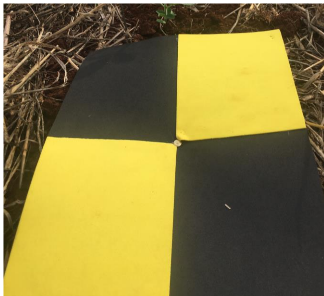
Figura 8 - Alvo utilizado para melhor identificação dos pontos de controle
