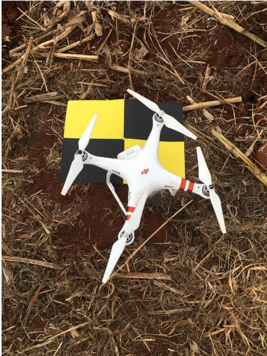
Figura 2- RPA utilizado para o levantamento (Phantom 3 Advanced)
