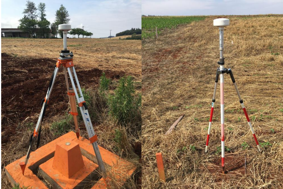
Figura 7- GPS utilizados como Base e Rover
