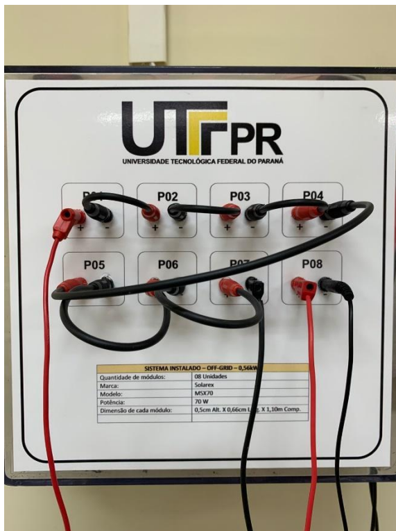
Figura 28 - Ligação da placa projetada à placa fotovoltaica
