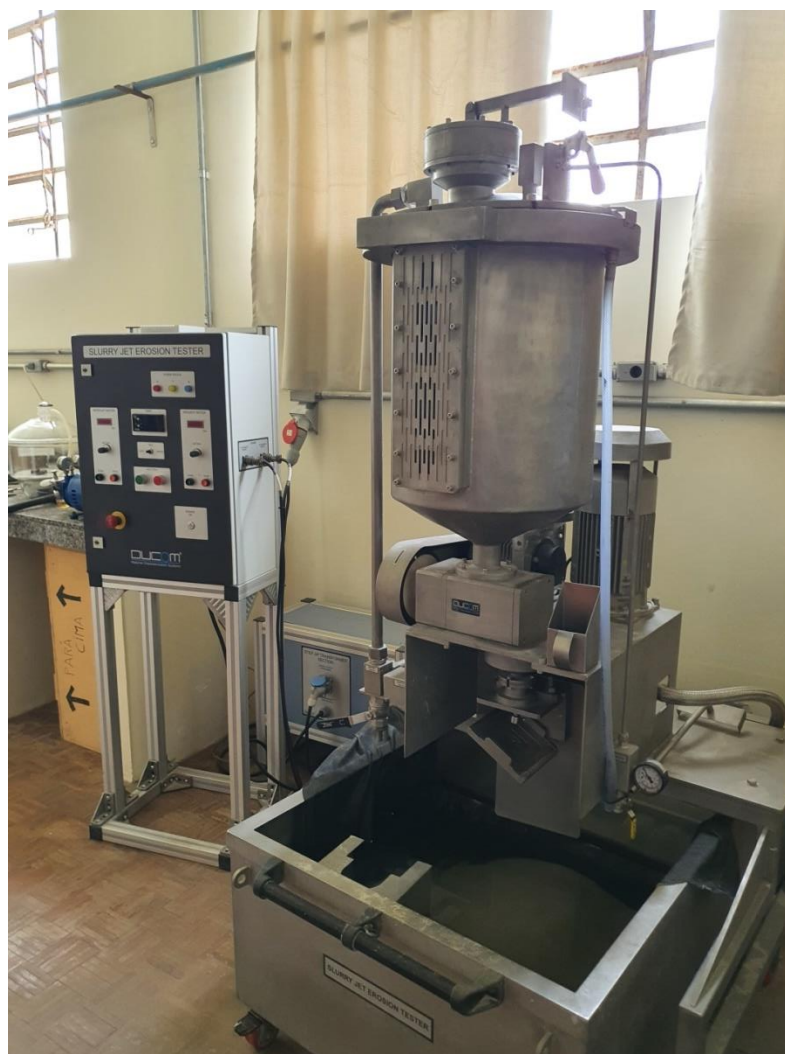
Figura 14. Equipamento para ensaio de Jato de lama.
