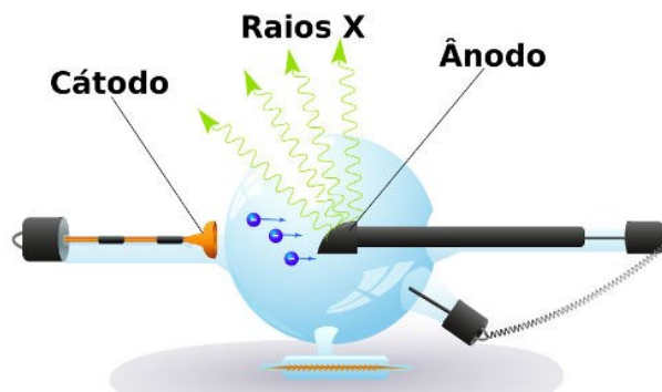
Figura 6 - Produção de fótons em um tubo de Raios X
